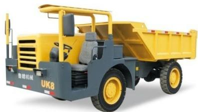
**UK-8矿用井下运矿车**根据巷道特点专业设计，四轮驱动，爬坡能力强，可达14°坡度;铰接式车架，转弯半径小，通过能力强;加粗铰接销轴，可靠耐用;全液压转向，方向转动轻便平稳;超低驾驶位置，整车高度低，特别适合低巷道;加装水过滤及化学净化装置，低碳环保;湿式制动，安全可靠;无级变速，操作舒适，轻巧方便。加厚厢板，坚固可靠耐用;四轮独立板簧结构，减震效果好，操作舒适;配装实心轮胎，防扎耐磨。湿式制动桥配置已获得国家《矿用产品安全标志证书》“KA”认证，产品符合国家关于安全、环保的政策要求。
