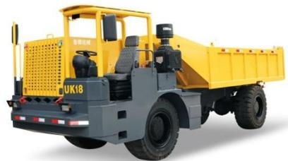
**UK-18矿用井下运矿车**车型选配潍柴DHL10G0137发动机，功率强劲，省油且排放低;电控前六后三动力换挡变速箱，操作灵活轻便;低速大扭矩，爬坡能力强，高速行驶快，效率高;湿式制动车桥,四轮驱动，载重能力强，牵引力爬坡能力大，可达14°坡度;四轮弹簧板减震，通过性好，驾驶舒适平稳，颠簸程度有效降低;四轮实心橡胶轮胎，承载能力强，防扎耐磨;低压保护断气刹驻车制动，安全保护到位;铰接式车架，转弯半径小;加厚厢板，加强型车架，经久耐用;双液压油缸转向，可靠轻便;后挡板自动开收功能;贵金属催化及特制水过滤装置双重发动机尾气处理，有效降低排放物标准;偏置驾驶位置，有效降低整车高度。本产品已获得国家《矿用产品安全标志证书》“KA”认证，符合国家关于安全、环保的政策要求。
