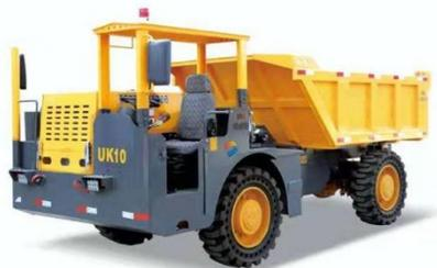
**UK-10矿用井下运矿车**选配潍柴潍柴国三WP4.IGJ25E302发动机，功率强劲，省油且排放低;液压换档变速箱，操作轻便;低速大扭矩，爬坡能力强，高速行驶快，效率高;湿式制动车桥，四轮驱动，载重能力强，牵引力爬坡能力大，可达14°坡度;四轮弹簧板减震，通过性好，驾驶舒适平稳，颠簸程度有效降低;四轮实心橡胶轮胎，承载能力强,防扎耐磨;铰接转向，转弯半径小;加厚厢板，加强车架，经久耐用;双液压油缸转向，可靠轻便;后挡板自动开收功能;贵金属催化及特制水过滤装置双重发动机尾气处理，有效降低排放物标准;偏置驾驶位置，有效降低整车高度。本产品已获得国家《矿用产品安全标志证书》"KA"认证，符合国家关于安全、环保的政策要求。
