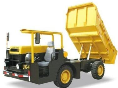
**UK-4矿用井下运矿车**根据巷道特点专业设计，四轮驱动，爬坡能力强，可达14°坡度;铰接式车架，转弯半径小，通过能力强;全液压转向，方向转动轻便平稳;超低驾驶位置，整车高度低，特别适合低巷道;贵金属催化及水排烟双重尾气净化处理，低排放、低污染;前后湿式制动车桥，行、驻车安全可靠;无级变速，操作舒适、轻巧方便;配装实心轮胎，抗扎耐磨;加厚厢板，坚固可靠耐用。湿式制动桥配置已获得国家《矿用产品安全标志证书》“KA”认证，产品符合国家关于安全、环保的政策要求。
