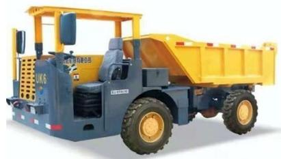
**UK-6矿用井下运矿车**根据巷道特点专业设计，四轮驱动，爬坡能力强，可达14°坡度;铰接式车架，转弯半径小，通过能力强;全液压转向，方向转动轻便平稳;超低驾驶位置，整车高度低，特别适合低巷道;贵金属催化及水排烟双重尾气净化处理，低排放、低污染;前后湿式制动车桥，行、驻车安全可靠;无级变速，操作舒适、轻巧方便;配装实心轮胎，抗扎耐磨;加厚厢板，坚固可靠耐用。湿式制动桥配置的已获得国家《矿用产品安全标志证书》“KA”认证，产品符合国家关于安全、环保的政策要求。
