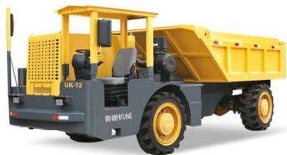
UK-12矿用井下运矿车选配潍柴WP6G175E331发动机，功率强劲，省油且排放低;电控前四后二动力换挡变速箱，操作轻便;低速大扭矩，爬坡能力强，高速行驶快，效率高;湿式制动车桥,四轮驱动，载重能力强，牵引力爬坡能力大，可达14°坡度;四轮弹簧板减震，通过性好，驾驶舒适平稳，颠簸程度有效降低;四轮实心橡胶轮胎，承载能力强，防扎耐磨;铰接转向，转弯半径小;加厚厢板，加强车架，经久耐用;双液压油缸转向，可靠轻便;后挡板自动开收功能;贵金属催化及特制水过滤装置双重发动机尾气处理，有效降低排放物标准;偏置驾驶位置，有效降低整车高度。本产品已获得国家《矿用产品安全标志证书》“KA”认证，符合国家关于安全、环保的政策要求。
